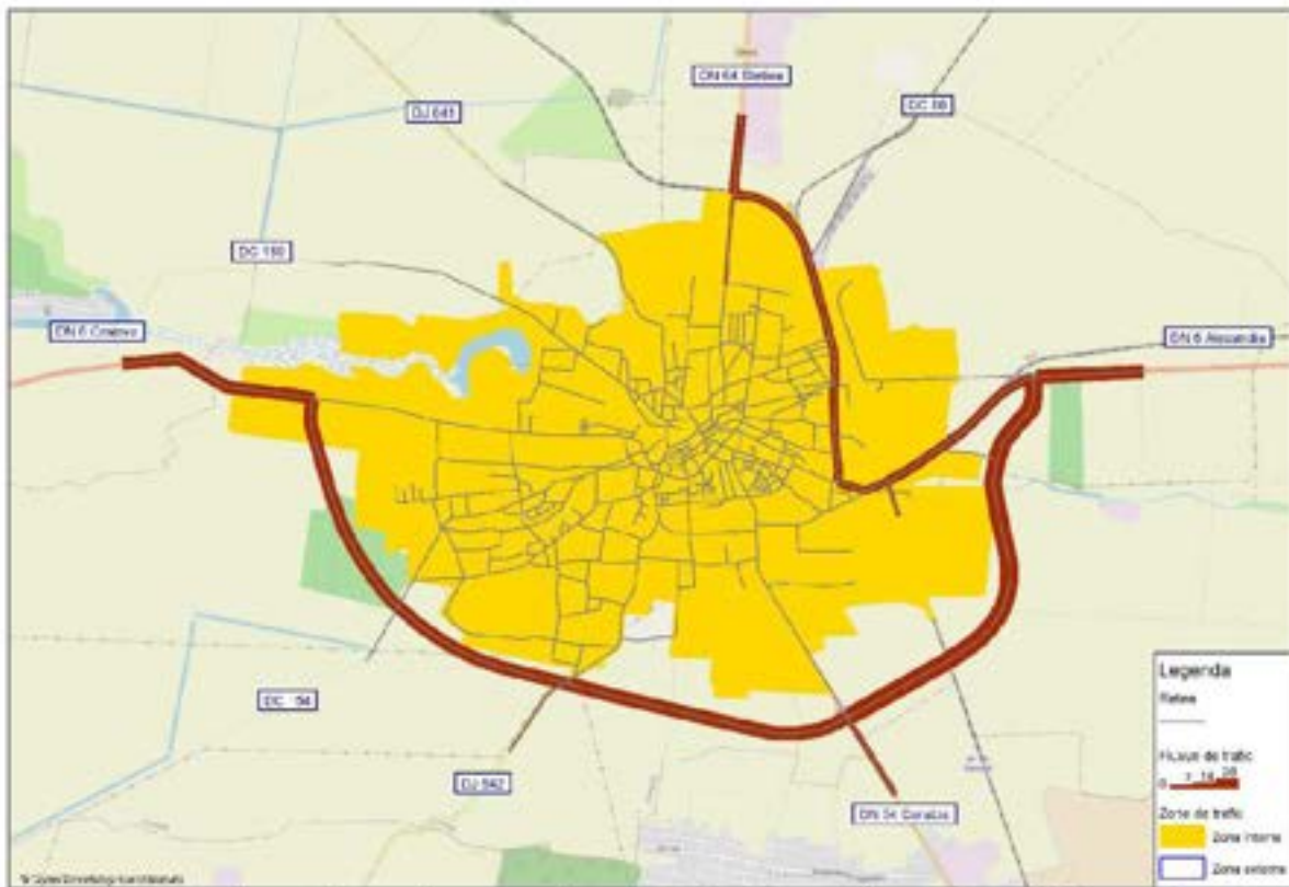
Figura 3.25. Fluxuri de trafic, autovehiculele grele de marfă, ora de vârf de trafic, 2021.
