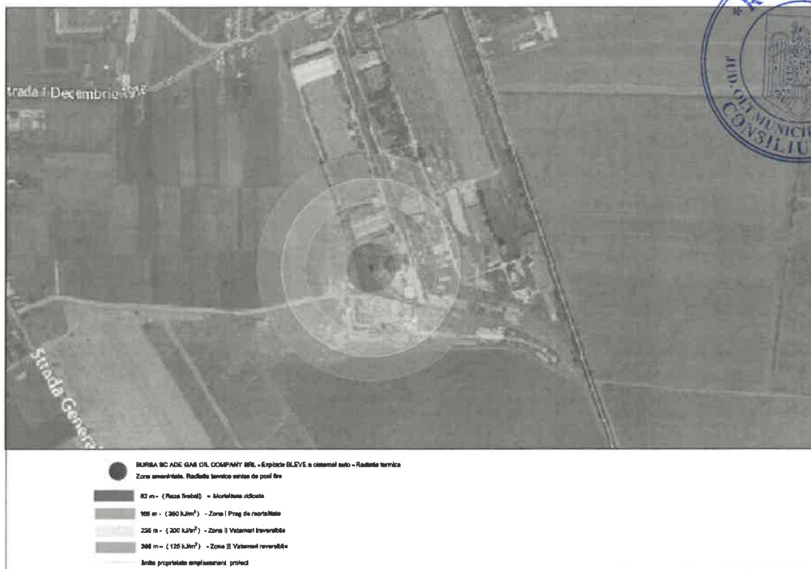
Figura 4.2. Amplasamentul proiectului în raport cu zona de amenințare în cazul exploziei BLEVE a cisternei CF – radiație termică emisă de "fireball"
