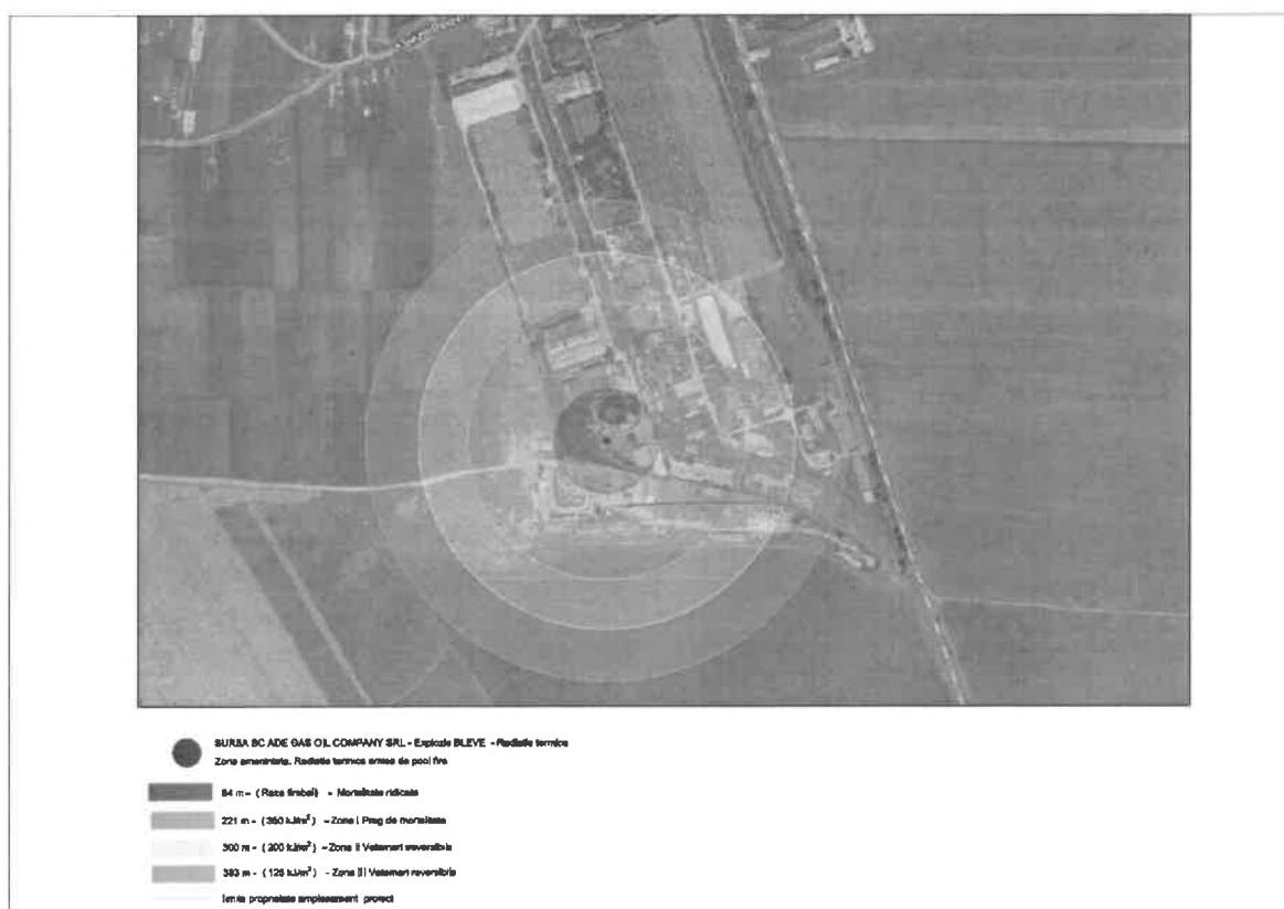
Figura 4.1. Amplasamentul proiectului în raport cu zona de amenințare în cazul exploziei BLEVE, rezervor 100 mc – radiație termică emisă de "pool fire"
